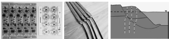
图 4 MEMS 传感器( 左)、测量单元( 中)、原理效果图( 右)
