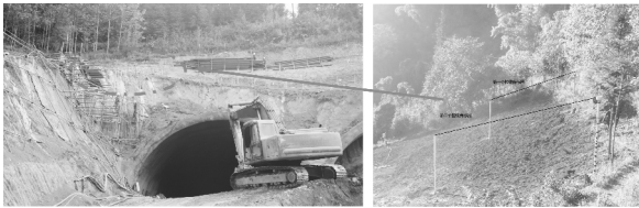
图 3 涡卷弹簧式地表变形测量仪现场实物图
