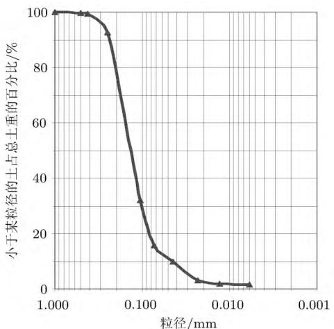
图 2 粉细砂颗粒级配曲线
