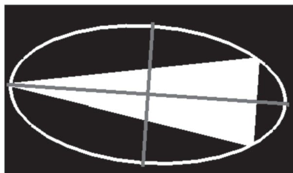
图9 尖锥模型与具有相同标准 2 阶矩椭圆的几何关系
