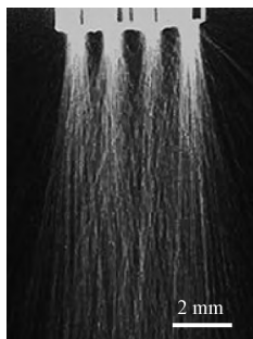
图 8 优化后喷嘴输出的粉末流分布
