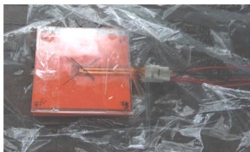
图 7 泡沫材料 TNT 爆炸冲击波加载试验
