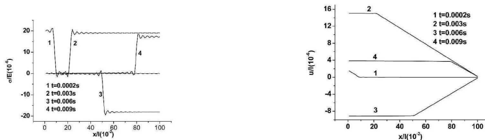
图7 突然卸载的影响 ( a=19.06\text{m/s} , b=9.53\text{s} ), 仅 t < 0.004\text{s} 时加载
