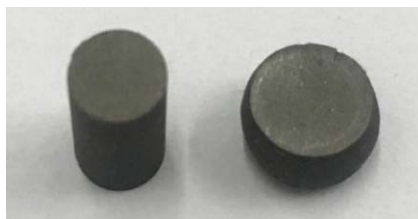
图 2 钨合金试件准静态压缩前后
