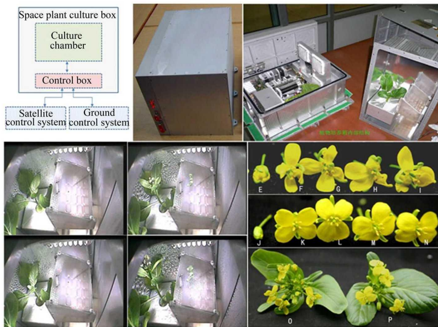
图 4 实践八号返回式卫星空间植物培养箱及空间微重力条件下青菜开花的实时图像 (重点观察微重力条件下青菜抽薹开花时间, 花瓣的展开状态和花粉的传播情况)
