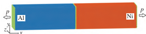
图 2 Al/Ni 双材料纳米杆拉伸分子动力学模型. 界面及端部标注为黄色
