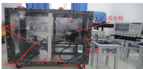
图4 电极移动速度效应测试仪样机实物
