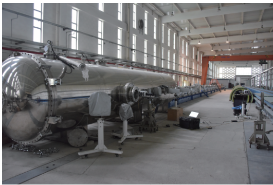
图 1 DBR30 二级轻气炮
