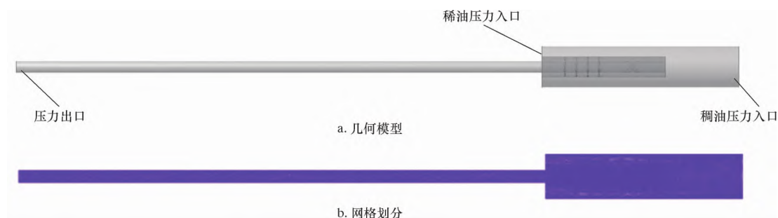
图3 稀油掺混数值模拟流场几何模型和网格划分示意图
