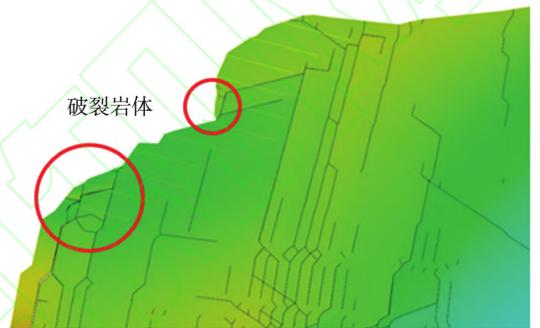
图15 坡体顶部破裂岩体(加固方案一)
