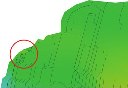
图 23 坡体顶部破裂岩体(加固方案三)
