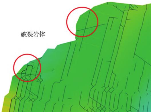
图 19 坡体顶部破裂岩体(加固方案二)
