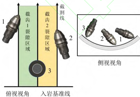
图 18 布齿系统中的基本破岩单元 Fig.18 The basic rock breaking unit in the tooth arrangement system
