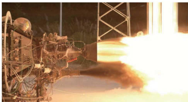
图4 某型商业火箭发动机二次启动60%节流工况试车
