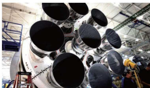
(1)“猎鹰”9尾段发动机多机并联
