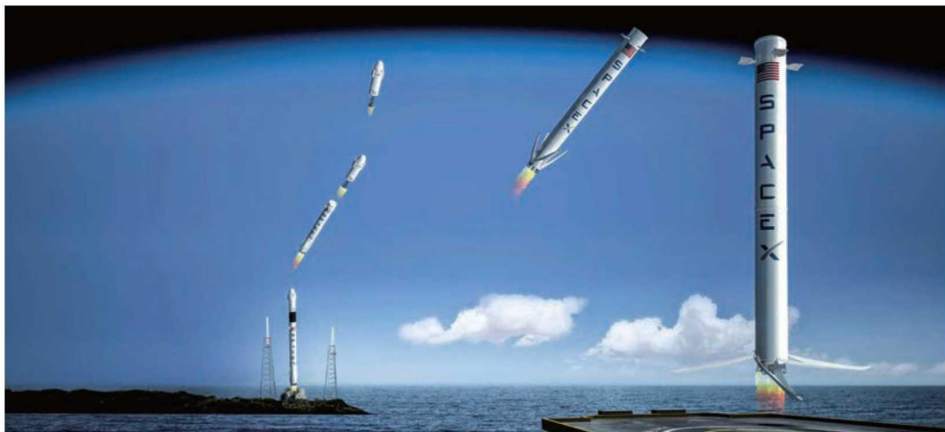
图9 “猎鹰”9火箭发射 / 回收全过程
