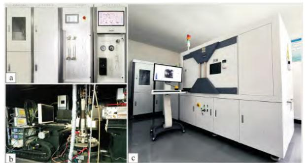
图 2 岩心流体驱替在线三维显微成像系统
