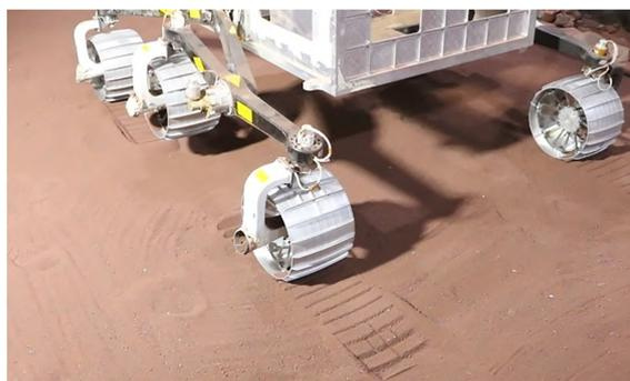
图 16 祝融号模拟车轮失效试验
