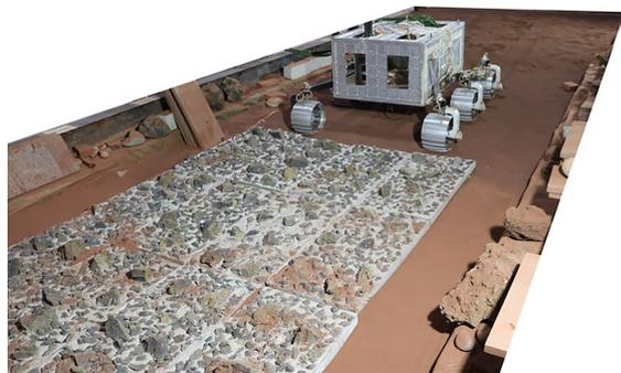
图 18 祝融号极端地面条件试验
