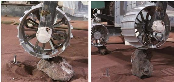
图 17 祝融号车轮跌落破坏试验
