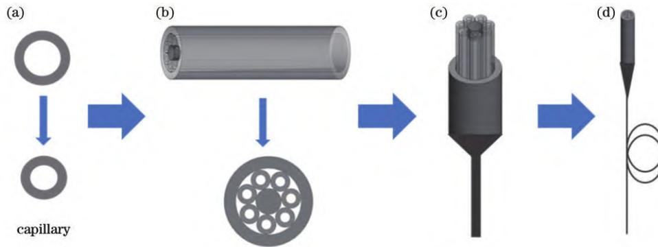
图 2 反谐振空芯光纤拉制流程。(a)拉制玻璃毛细管;(b)堆叠毛细管;(c)拉制光纤预制棒;(d)拉制光纤
