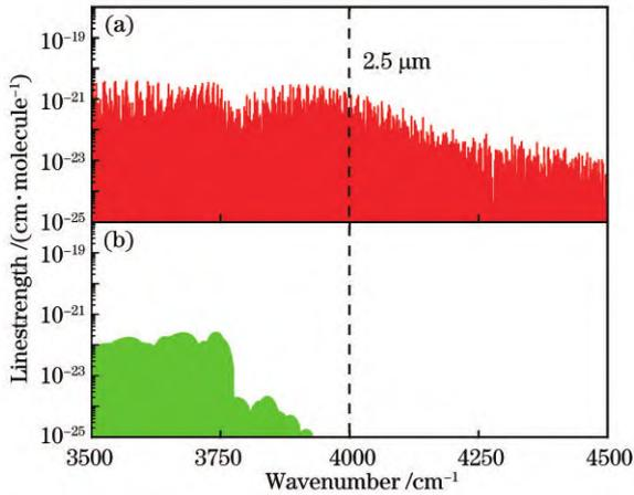
图 6 2000 K 时 H<sub>2</sub>O、CO<sub>2</sub> 的近红外和中红外波段的线强(数据来自 HITRAN2016)。(a) H<sub>2</sub>O;(b) CO<sub>2</sub>
