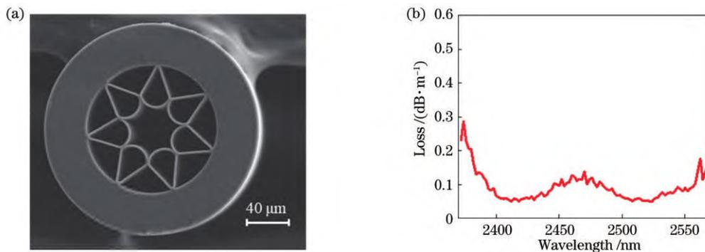
图 3 反谐振空芯光纤参数。(a)光纤端面的扫描电子显微镜图(光纤外径为  $220 \mu\text{m}$ ,纤芯直径为  $43 \mu\text{m}$ );(b)光纤损耗谱
