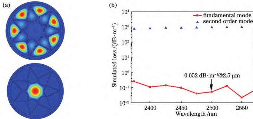
图 4 冰淇淋型反谐振空芯光纤的模场特性和传输特性仿真结果。(a)光纤中传输波长为 2.5 μm 时的 HE<sub>11</sub> 模和二阶模;(b)基模和二阶模的损耗
