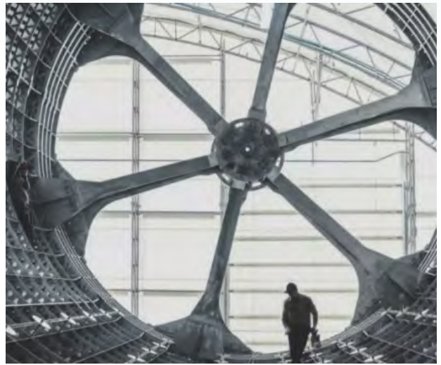
图1 成本高昂的复合材料贮箱模具
