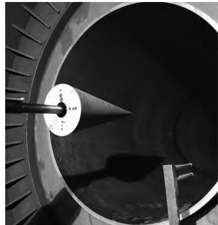
(a) 模型-天平-支撑测力系统
