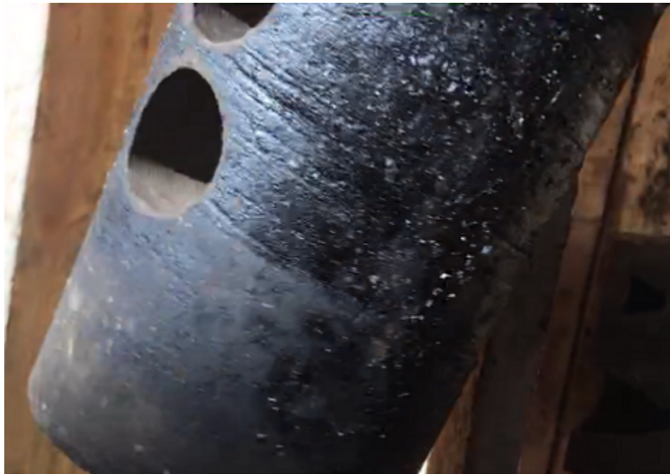
图1 富含原油的地下3500米页岩样品（作者采集自中国新疆准噶尔盆地）
