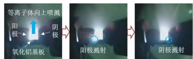
图 2 CCD 相机拍摄真空电弧放电主要过程图片
