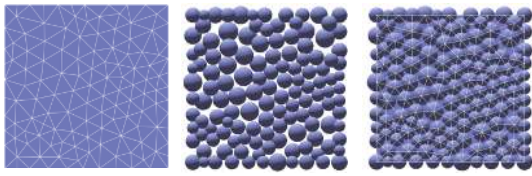
图 4 基于共享节点的 FEM-DEM 耦合模型建模过程
