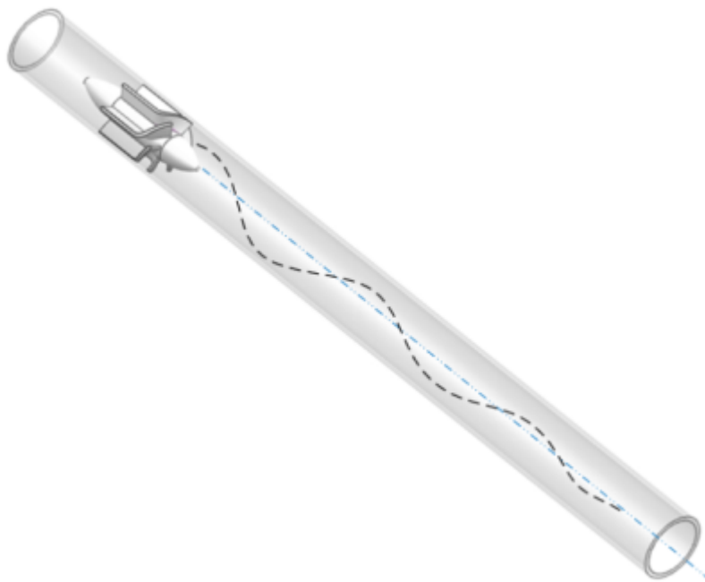
图10 旋流分离装置中颗粒运动轨迹示意（图片来源：作者自制）
