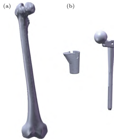
图 1 (a) Crowe IV 型股骨建模; (b) 假体模型, 左为袖套, 右为假体柄和球头
