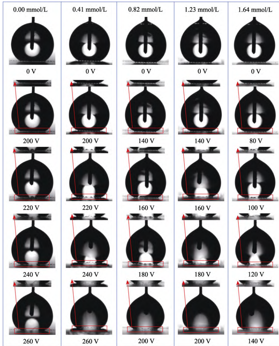
图 8 SDS 水溶液液滴在固相分数为 0.20 的微凹槽阵列 PDMS 表面上沿 T 方向上的电润湿实验快照
