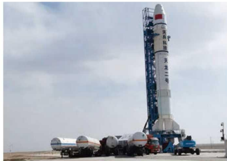
图26 “天龙”二号遥一火箭民用槽车
