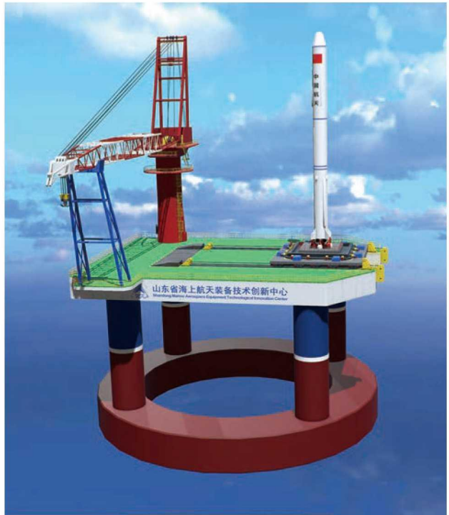
图30 半固定式海上发射平台示意图
