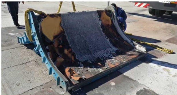
图3 “朱雀”一号遥一火箭发射后的导流器
