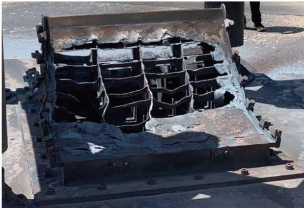
图5 “双曲线”一号遥一运载火箭烧毁的导流器
