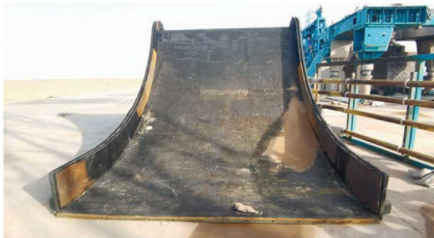
图 27 “天龙”二号遥一火箭发射后的导流器
