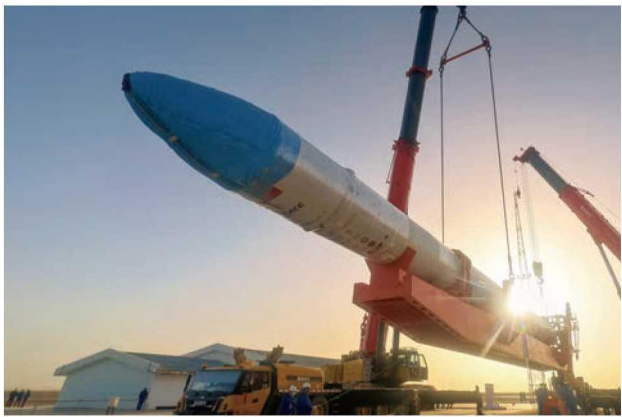
图7 “双曲线”一号遥六火箭双吊车起吊翻转架
