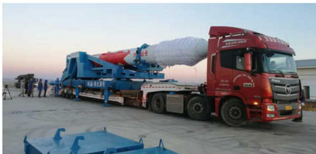
图1 运输车倒车,“朱雀”一号遥一火箭起竖架准备对接发射台
