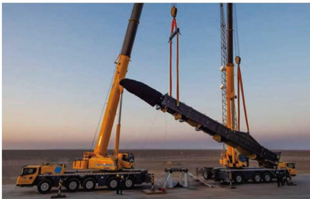
图10 “谷神星”一号遥一火箭双吊车翻转架起竖
