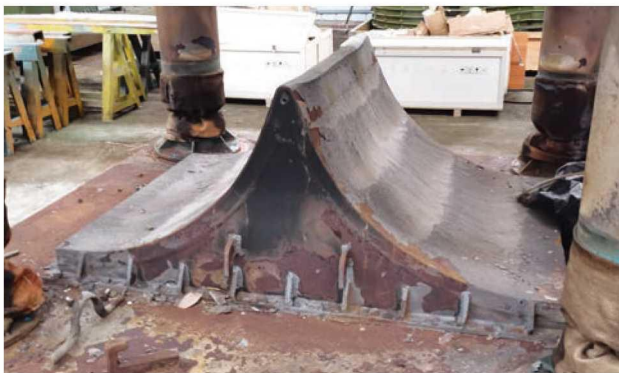
图9 “双曲线”一号火箭改进的导流器
