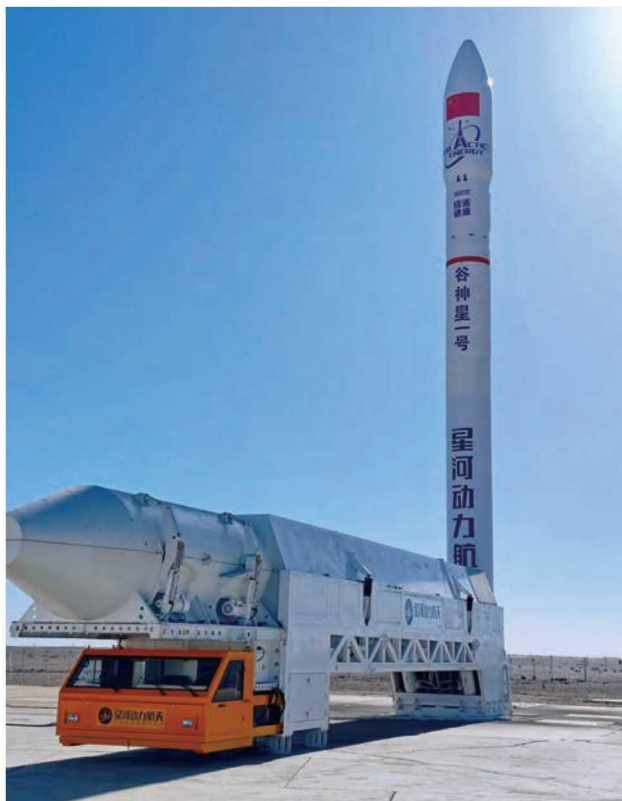
图11 “谷神星”一号运输发射车
