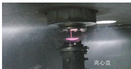
图 4 转盘雾化制备球形铝粉的实验图片
