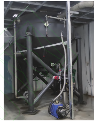
图 2 高温转盘雾化制粉实验装置照片
