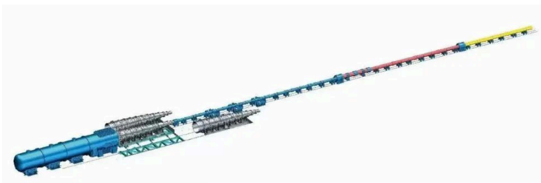
图10 力学所新建成的JF22超高速风洞图示（图片来源：自制）
