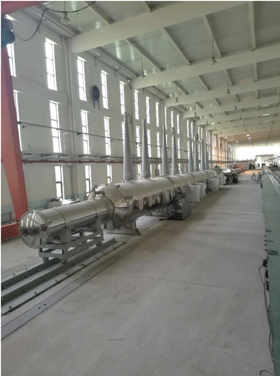
图7 一个典型的弹道靶装置（图片来源：力学所官网）
