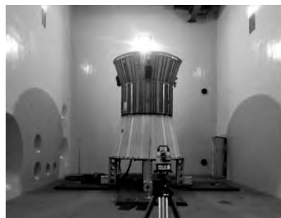
图2 舱段组合体噪声试验
