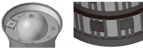
图5 内部结构设备有限元模型
