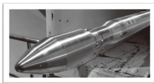
图3 舱段组合体噪声试验
