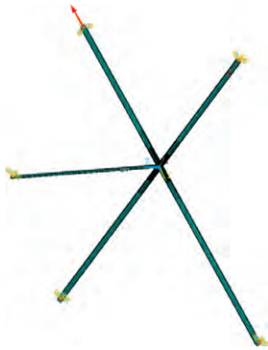
图 14 有面外支撑 X 撑结构有限元模型
