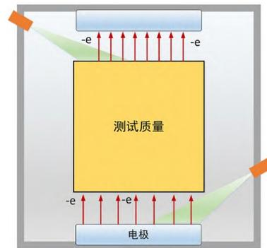
图11 (网络版彩图)测试质量电荷管理原理
