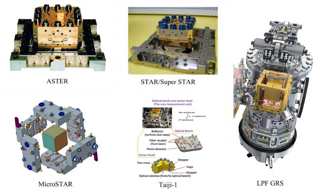
图 6 (网络版彩图)各类型空间惯性传感器的结构形式<sup>[40,41,44,46,49]</sup>
