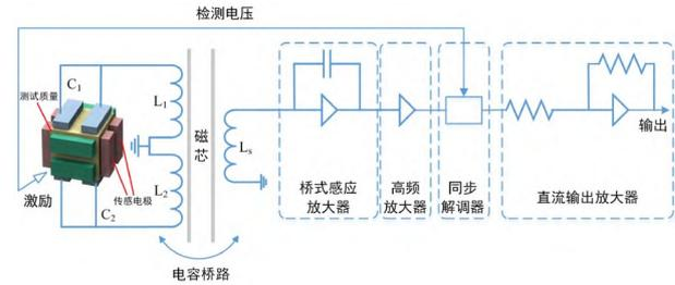
图8 (网络版彩图)电容传感原理图
