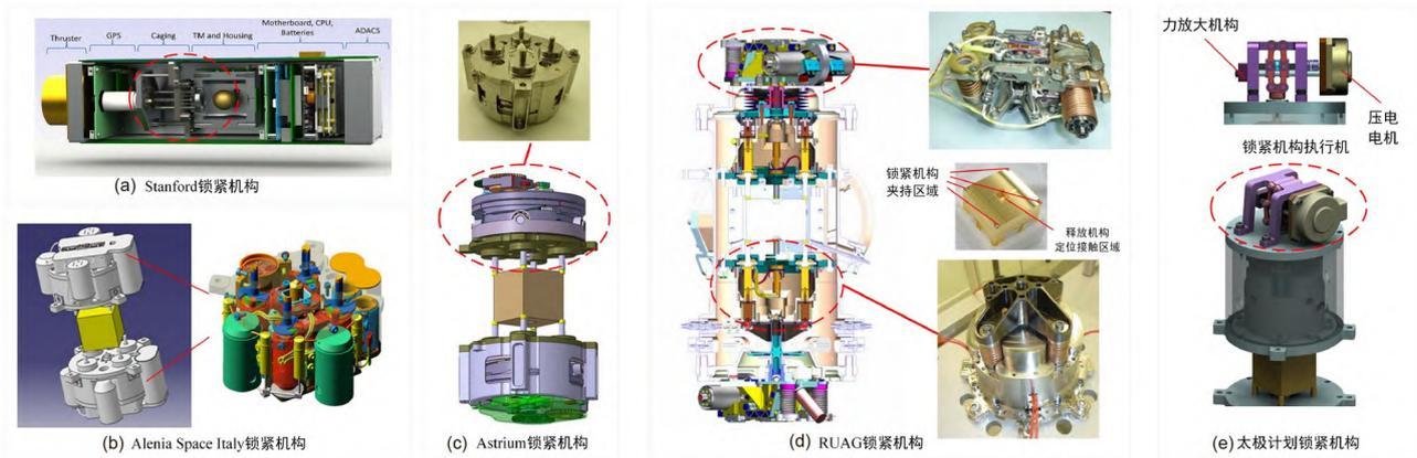
图 13 (网络版彩图)不同类型的惯性传感器锁紧机构<sup>[31,89-93]</sup>. (a) 斯坦福大学球形测试质量电机螺杆锁紧机构; (b) Alenia Space Italy液压测试质量锁紧机构; (c) Astrium凸轮减速器测试质量锁紧机构; (d) RUAG石蜡驱动器摩擦轮测试质量锁紧机构以及测试质量夹持结构特征; (e) 太极计划压电电机驱动力放大结构的测试质量锁紧机构
