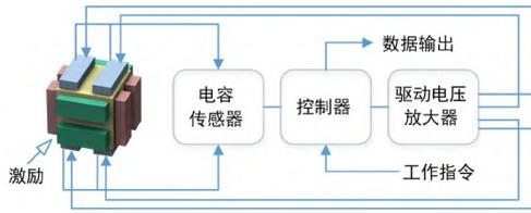
图9 (网络版彩图)静电力驱动控制原理
