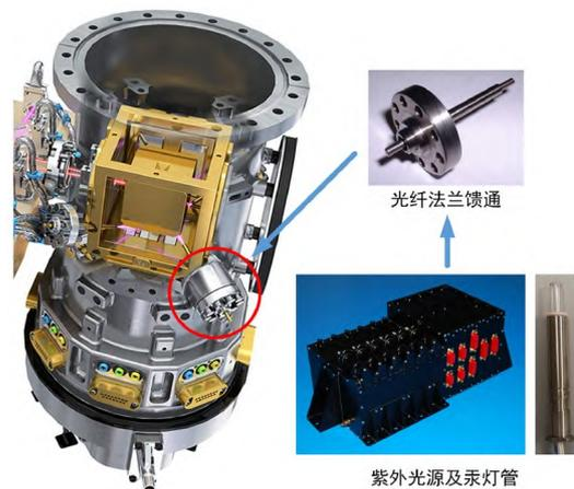
图12 (网络版彩图) LPF电荷管理系统<sup>[79]</sup>
