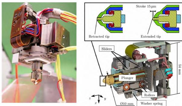
图 15 (网络版彩图)释放机构组成结构<sup>[96]</sup>
