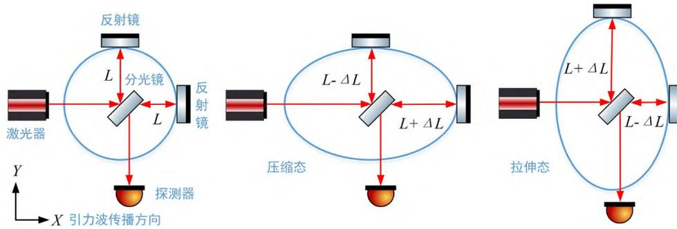
图1 (网络版彩图)激光干涉测量引力波原理
