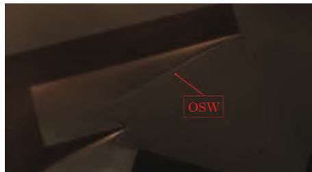
(b) 斜激波 (Test 4)
